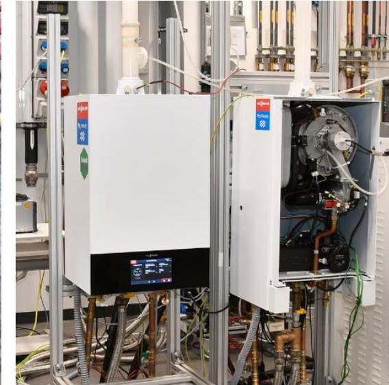
*Viele Gas-Brennwertgeräte sind bereits so gebaut, dass sie mit **100 % Wasserstoff** betrieben werden können!*
