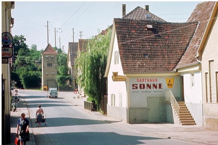
Blick auf die Trafostation Ecke Lauffener Str./Südstraße. In dieser Turmstation wurde die Mittelspannung heruntertransformiert auf 380V Drehstrom (heute 400V) bzw. Wechselstrom /Wechselspannung (früher 220V, jetzt 230V).
