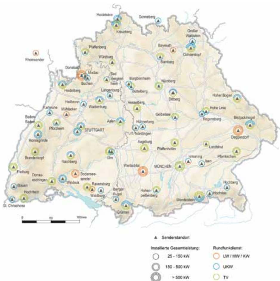
Standorte von Radio- und Fernsehsendern in Baden-Württemberg und Bayern mit einer installierten Gesamt-Sendeleistung (ERP) von mindestens 25 kW. Quelle: LfU, LUBW
