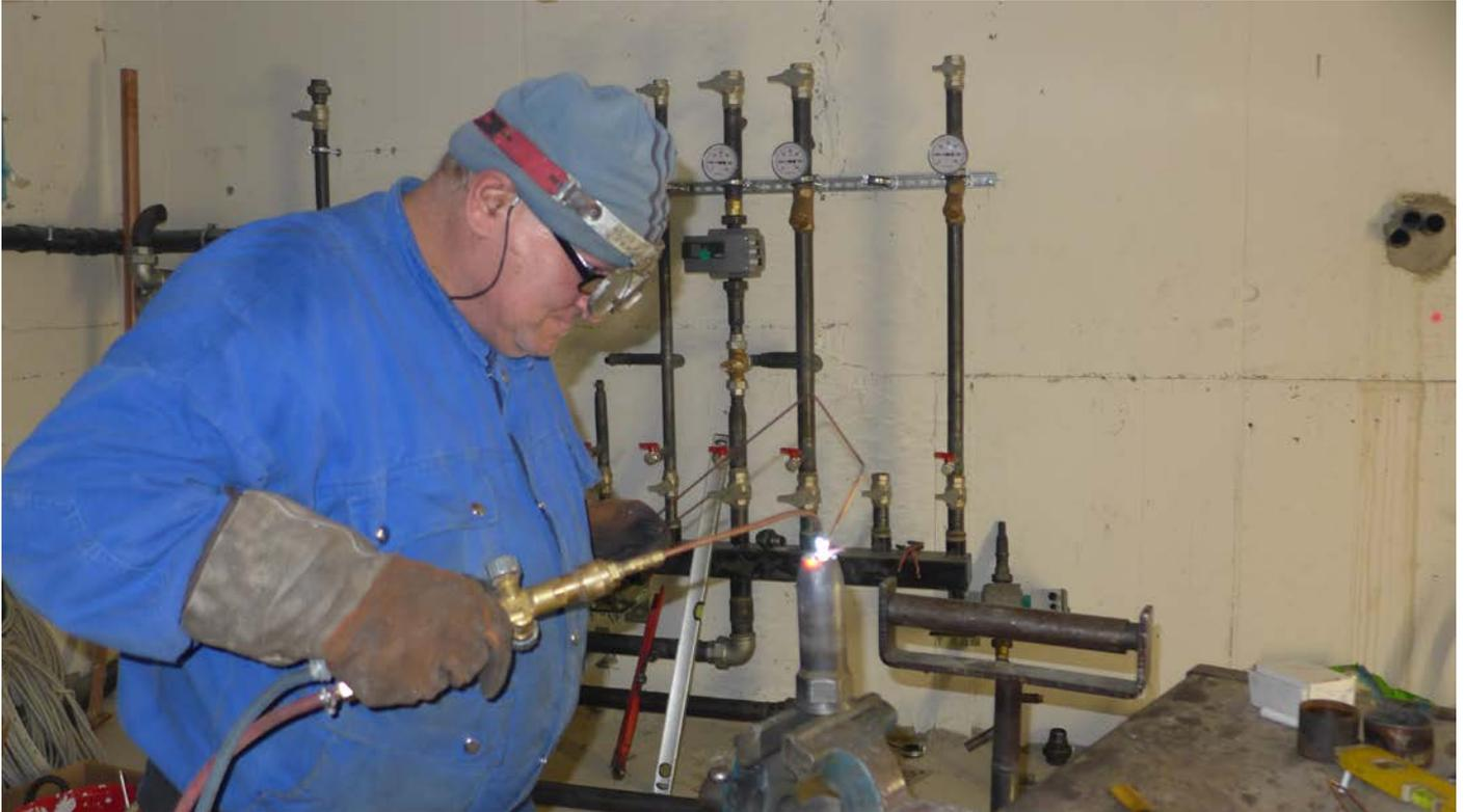
*Mit einer Lötflamme werden die Werkstücke zuerst erwärmt und über das Lot verbunden.*
