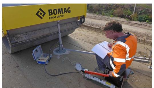
Mehrfach wird gemessen und dokumentiert, ob der Untergrund ausreichend tragfähig aufgebaut wurde.
