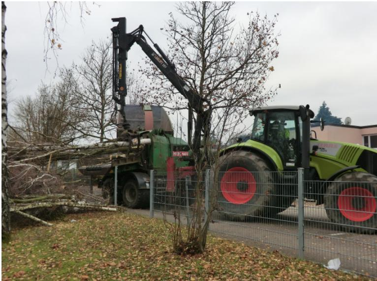
Mit einem 300 PS – Schlepper wird der „Holzacker“ angetrieben. Bis zu 60 cm Stammumfang können die Baumstämme haben, die in den „Hacker“ geschoben werden, um kleingehäckselt in einen bereitstehenden Großraumcontainer geblasen zu werden.
